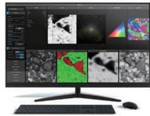
STEM 像、EDS マップと回折パターンを同時取得し、相・方位マップをほぼリアルタイムで表示している TENSOR のユーザーインターフェイス画面
