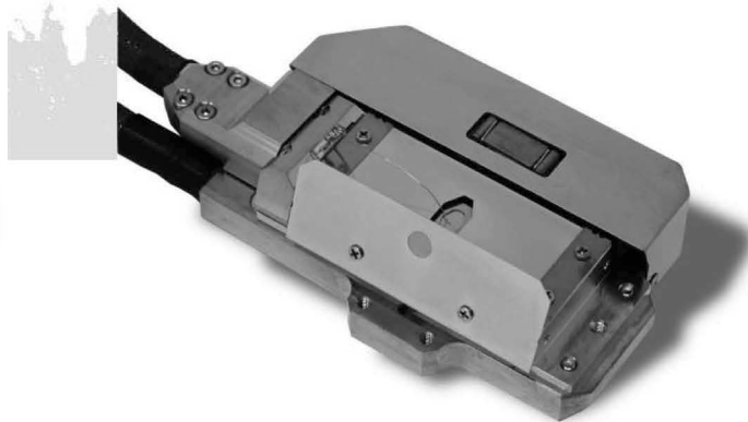
OIM 用試料加熱装置(Max 1000°C)
